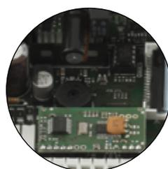
INTEGRIERTER EMPFÄNGER 433 ODER 868MHz
